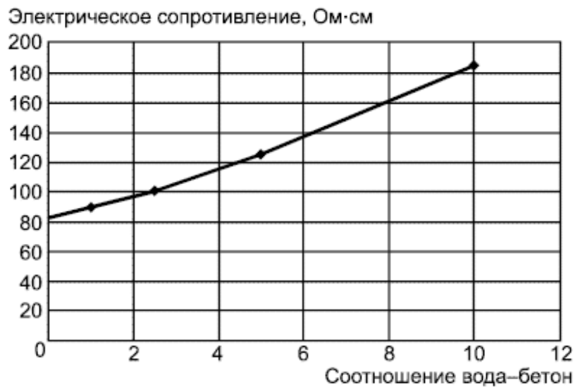
Рисунок 4 - Оценка электрического сопротивления водной вытяжки из бетона
